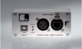
netzwerkfähig / fernsteuerbar mit NA-1 Fohhn-Net USB Adapter
